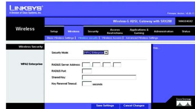
Abbildung 6-19: „Wireless Security“ (Wireless-Sicherheit) – „WPA2 Enterprise“
