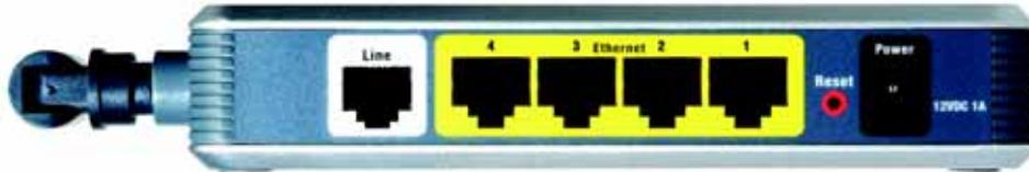
Figure 3-1 : Ports et bouton Reset (Réinitialisation) du panneau latéral
