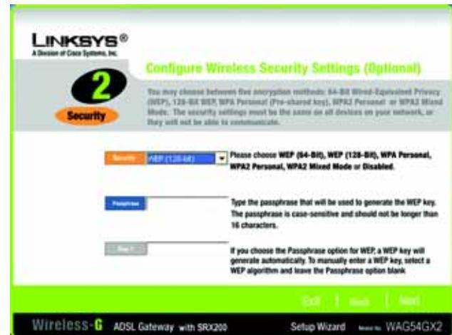
Figure 5-23 : Ecran Wireless Security - WEP (128-Bit) (Sécurité sans fil - WEP (128 bits)) de l'assistant de configuration
