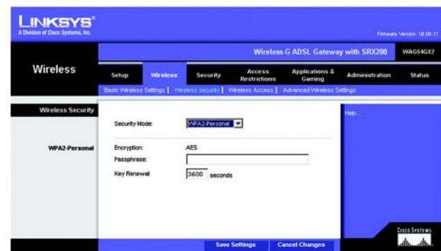
Abbildung 6-16: „Wireless Security“ (Wireless-Sicherheit) – „WPA2-Personal“
