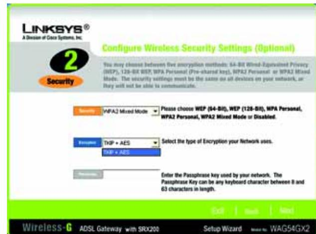
Figure 5-21 : Ecran Wireless Security - WPA2 Mixed Mode (Sécurité sans fil - WPA2 mode mixte) de l'assistant de configuration
