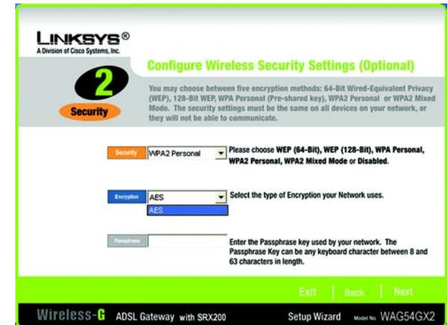
Abbildung 5-20: Setup-Assistent – Fenster **Wireless Security (Wireless-Sicherheit)** – „WPA2 Personal“
