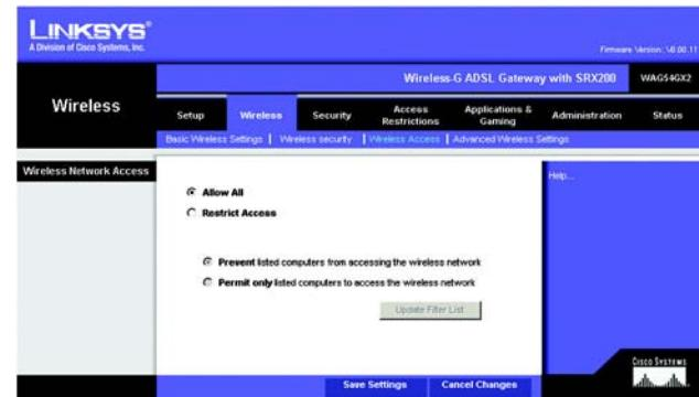
Abbildung 6-21: „Wireless Access“ (Wireless-Zugriff)
