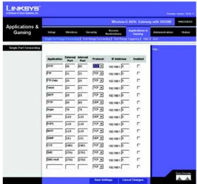
Figure 6-36 : Single Port Forwarding (Transfert de connexion unique)
