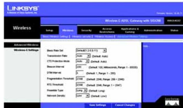
Figure 6-24 : Advanced Wireless Settings (Paramètres sans fil avancés)
